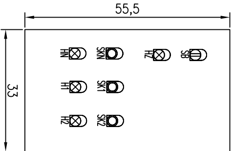
ELEMACJA TABLICY STEROWANIA AS OBUDOWA RXL IP41
